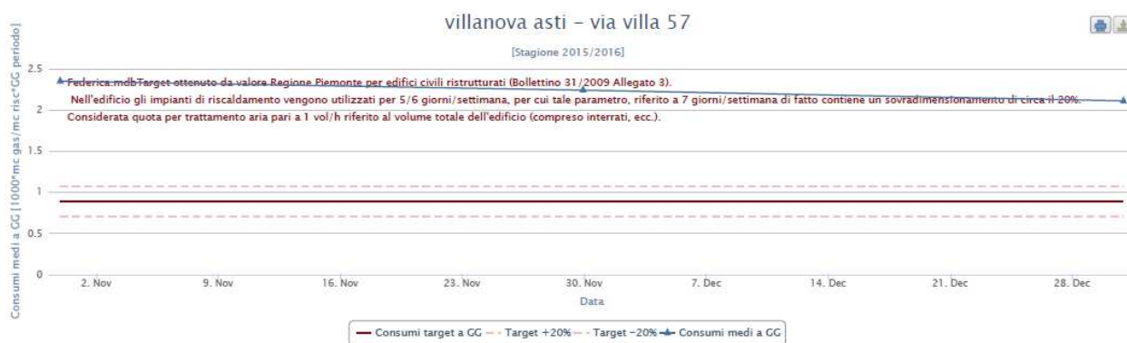
Figura 28 - Consumo per Unità Climatica dell'edificio scolastico riferita alla stagione di riscaldamento 2015/16
