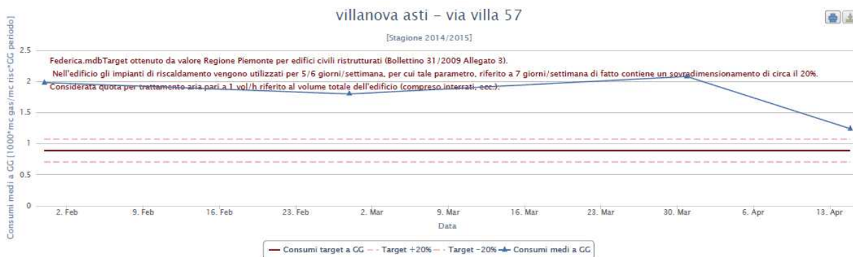
Figura 26 - Consumo per Unità Climatica dell'edificio scolastico riferita alla stagione di riscaldamento 2014/15
